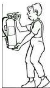
1. Descolgar el extintor asiendo por la maneta o asa fija y dejarlo sobre el suelo en posición vertical.
