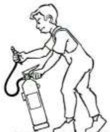
2. Ajar la boquilla de la manguera del extintor y comprobar, en caso que exista, que la clavija o dedo de seguridad (s) está en posición sin riesgo para el usuario. Sacar el pasador de seguridad tirando de su anillo.
