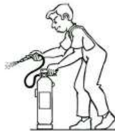
3. Presionar la palanca de la cabeza del extintor y en caso de que exista apretar la palanca de la boquilla realizando una pequeña descarga de comprobación.
